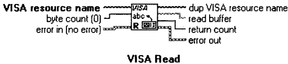
Рис. 11.56. VISA Чтение (VISA Read) . Считывает данные из прибора
