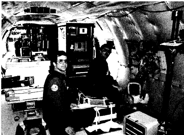
Рис. 1.1. Листовая печь зонной плавки создана в аэрокосмической промышленности США и предназначена для высокотемпературной обработки полупроводниковых материалов в условиях микрогравитации на борту самолета NASA KC-135, движущегося по специальной параболической траектории. Ее работа автоматизирована с помощью LabVIEW через промышленный компьютер на базе Macintosh
